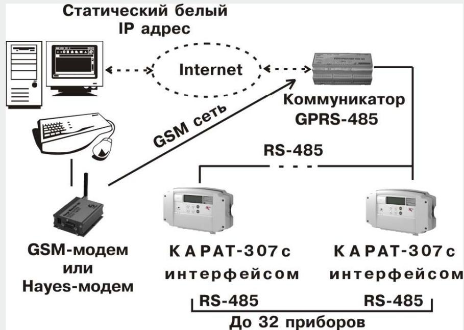
«GPRS с инициативой сервера, динамический IP адрес на стороне узла» – диспетчерская система осуществляет вызов коммуникатора в режиме «голосовой вызов». При совпадении телефонного номера звонящего со списком в коммуникаторе, он связывается с сервером диспетчерской системы (возможно настроить соответствие 5 телефонных номеров и IP адресов)
