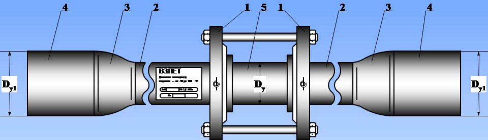
**1 – фланец; 2 – прямолинейный отрезок трубопровода; 3 – концентрический переход; 4 – монтажный патрубок; 5 – имитатор.**
