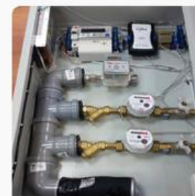
Демонстр. станция LW 1. Устройство LW 2. Счетчики ГВС/ХВС, газа, электричества 3. Электрофен
