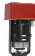
TA-MC100 FSE/FSR с возвратной пружинной FSE: Шток выдвигается при отключении питания FSR: Шток втягивается при отключении питания 24 В AC/DC пророрц. / 3-точ. 230 В AC 3-точ.
