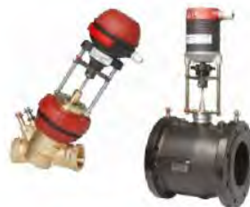
TA-FUSION-C DN 32-150, PN16/25, -20/150 °C настраиваемый Kvs Для пророрц. /3-точ. рег. Равнопроц. (EQM)
