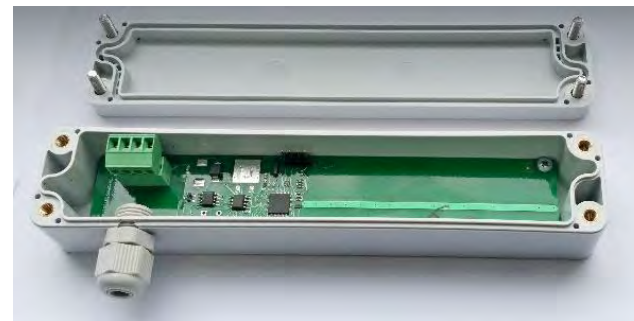
Координатор сети (с интерфейсом RS-485)
