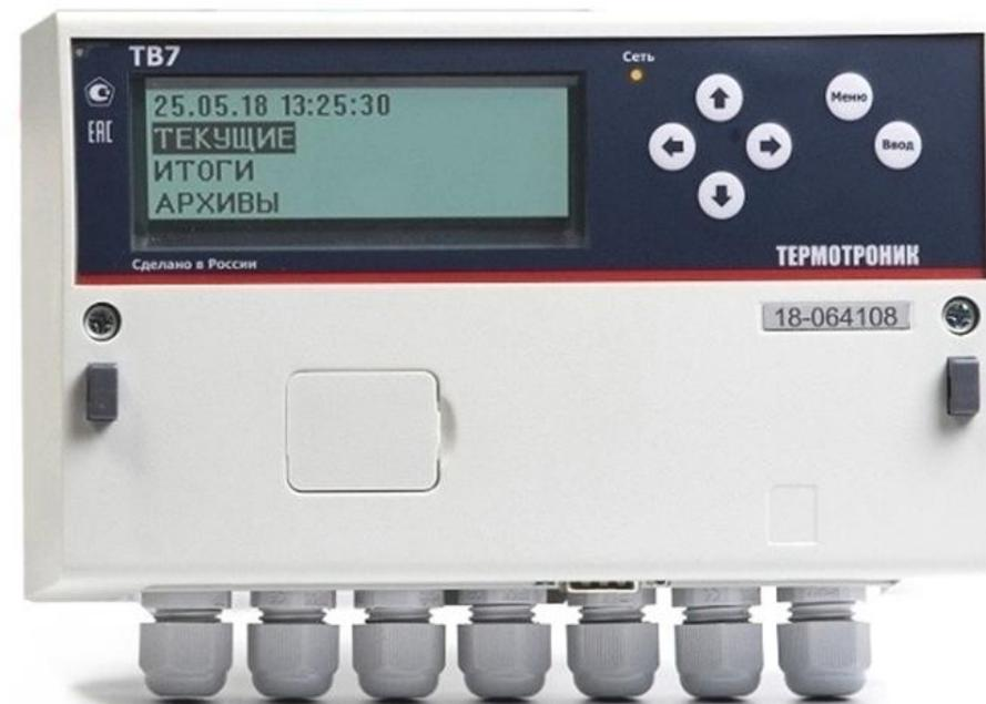
Тепловычислитель ТВ7 предназначен для расчета, накопления и архивирования данных о количестве тепловой энергии, количестве и параметрах теплоносителя в одной или двух закрытой и/или открытой **водяных системах теплоснабжения**, а также для учета потребления холодной водоснабжения
