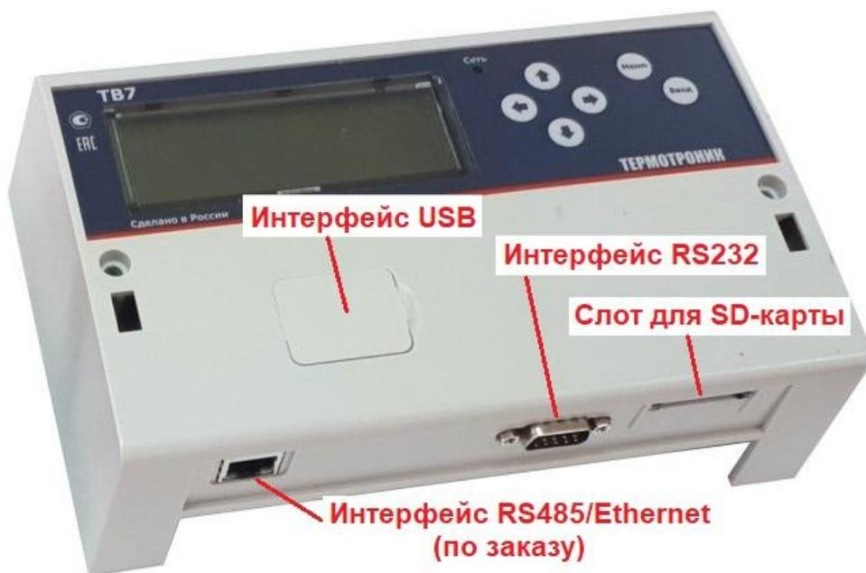
2 независимых последовательных канала передачи информации:
