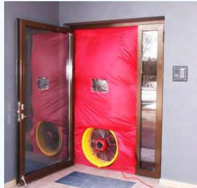
**Тест №.3 был проведён одной Аэродверью 14000 m<sup>3</sup>/h)
