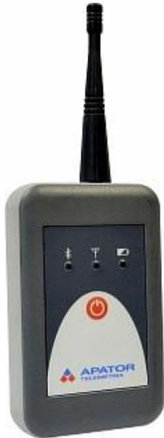
Конвертер AT-WMBUS-02 является частью обходной системы диспетчеризации и специально разработан для работы с модулями WMBUS фирмы APATOR S.A. **Использование в других системах не допускается.** Конвертер не имеет регистров памяти и используется только для передачи данных с радиомодулей на КПК с предустановленным программным обеспечением.
