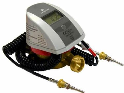
Компактный теплосчетчик Elf-M представляет собой электронный вычислитель и два датчика температуры Pt 500, выполненный в едином корпусе с тахометрическим счетчиком воды, и предназначен для измерения тепловой энергии и параметров теплоносителя в закрытых системах централизованного теплоснабжения, на объектах с небольшим теплоснабжением (например, в квартирах) с мощностью от 0,3 до 85 кВт., где теплоносителем является вода, соответствующая требованиям действующего СНиП.
