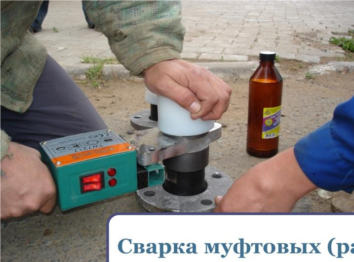
**Сварка муфтовых (раструбных) соединений**
