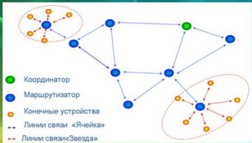
Применение технологии ZigBee в пределах здания позволяет охватить мониторингом любое помещение без прямой прокладки в него кабельных линий. Данная возможность позволяет без проблем подключать к Системе квартирные приборы учёта, что особенно актуально в существующем жилищном фонде.
