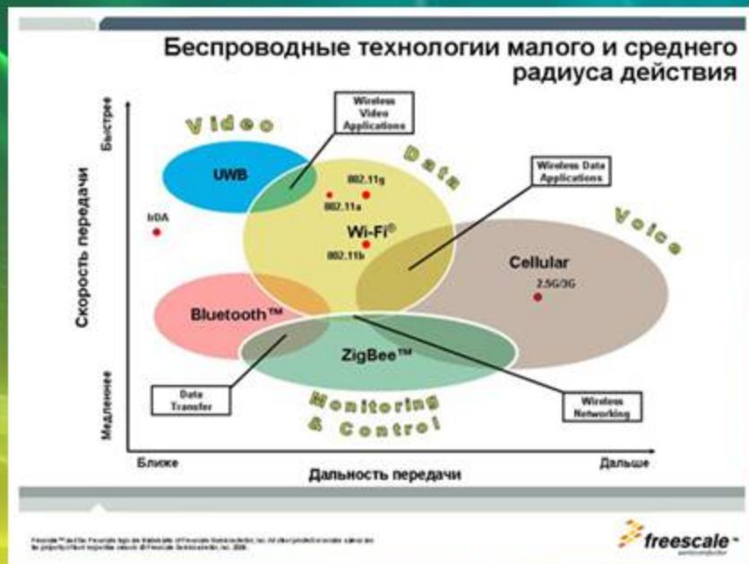
Для информационного обмена оборудования мониторинга в пределах здания (объекта мониторинга) преимущественно используются беспроводные защищенные каналы передачи данных на основе стандарта ZigBee – беспроводные технологии малого радиуса действия стандарта IEEE 802.14.15.
