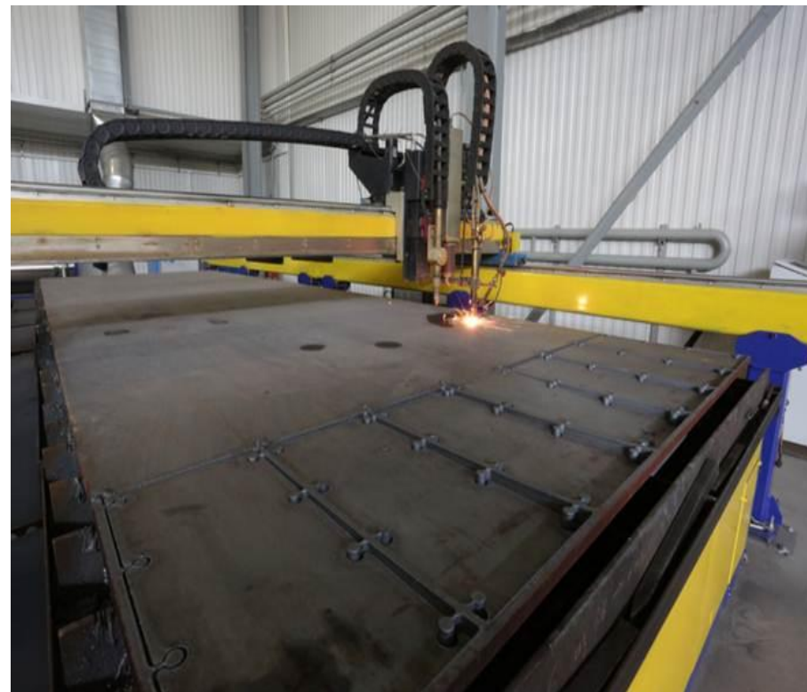
Автоматический раскрой прижимных плит
