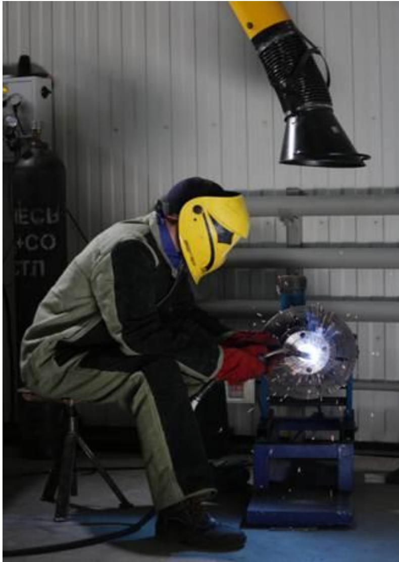
Сварка патрубков для теплообменника
